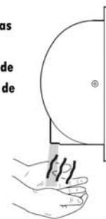
2. El XLERATOR se detiene automáticamente al retirar las manos del sensor, o después de un máximo de 35 segundos de operación continuada.
